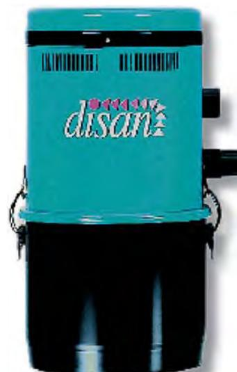
Centrale aspirante en tôle d'acier vernie, revêtue d'une poudre époxy anticorrosion, bac à poussière amovible, carte électronique commande prises 12 Volts incorporée, moteur by-pass radial, isolant phonique dans le compartiment moteur, coupe-circuit thermique, fusible, système cyclonique, filtre à cartouche, raccordement pour réseau de canalisations, support pour pose murale, support de sac avec 2 sacs poussière en plastique, norme CE.
